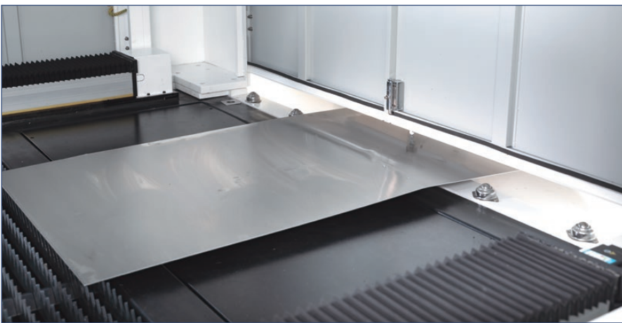
Eine Gehäusedurchführung ermöglicht die Bestückung mit Blechtafeln im Klein- und Mittelformat
