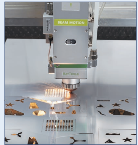
Hochwertiger Laserschneidkopf mit Auto-fokus aus dem Hause RayTools
