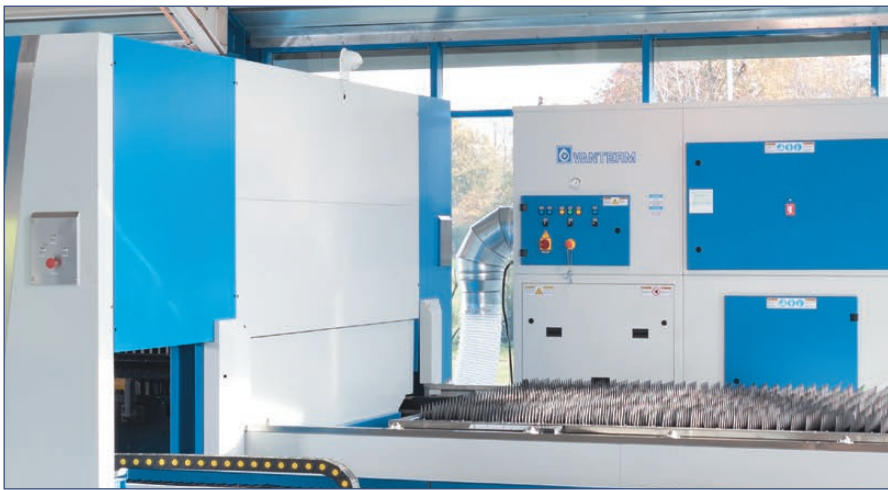
Filterabsauganlage mit Staubabscheider und Filtrationseinheit
