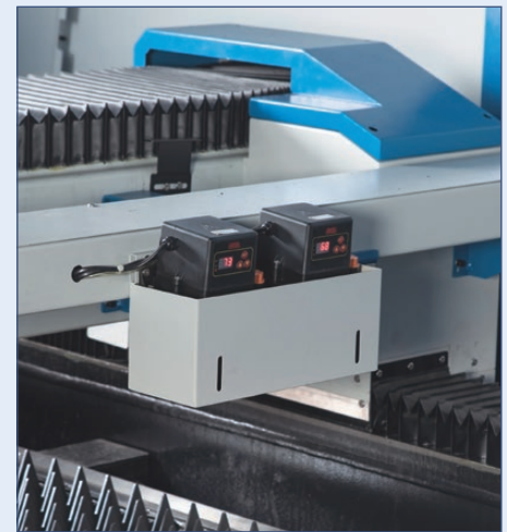
Zentralschmierung: minimierter Wartungsaufwand, erhöhte Zuverlässigkeit
