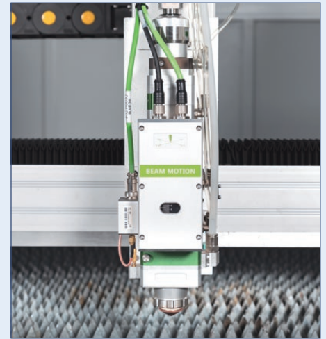
Schneidkopf mit integriertem Kollisionsschutz, automatischer Fokuslagenverstellung und Höhenkontrolle
