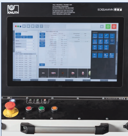
Leistungsstarke Eckmann CNC-Einheit mit 19" Touchscreen von ELO
