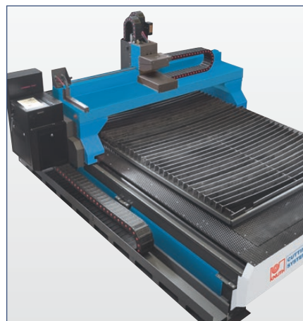
Durch separate Aufstellung keine thermischen oder mechanischen Einflüsse auf die Führungsmaschine
