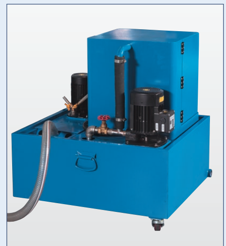
Der separate Dielektrikumtank verfügt über eine effektive Filtereinheit
