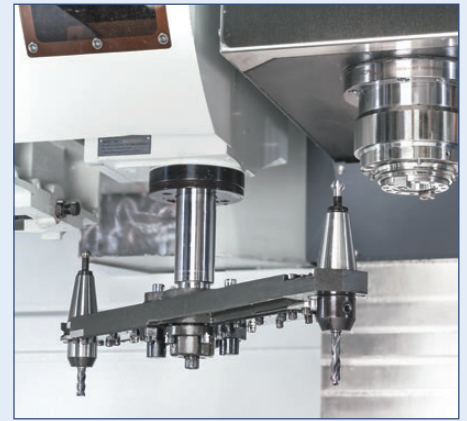
Werkzeugwechsler mit Doppelarm und Spindel
