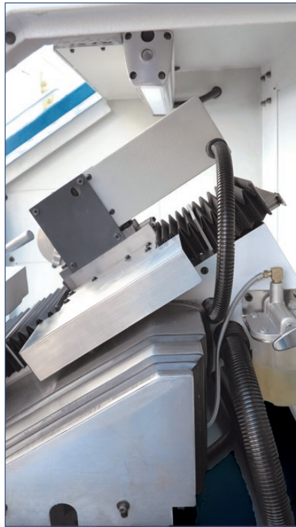
Schrägbettbauweise für optimierter Späneabfuhr
