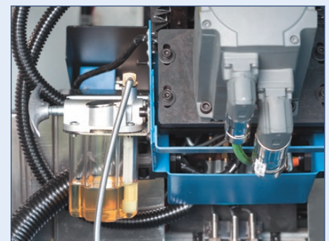
Die manuelle Zentralschmierung minimiert Wartungszeiten
