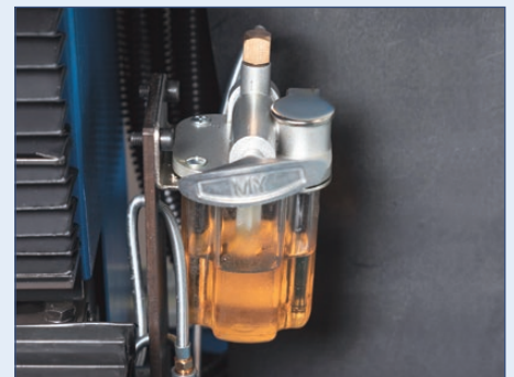
Die Zentralschmierung erleichtert die Wartung der Maschine
