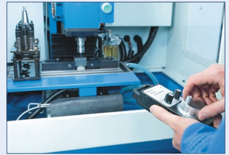
Ein elektronisches Handrad erleichtert dem Bediener das Einrichten der Maschine
