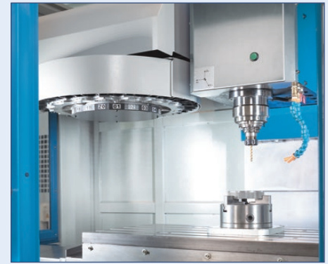
Der robuste armlose Werkzeugwechsler mit 20 Stationen sorgt für Flexibilität im Produktionsalltag
