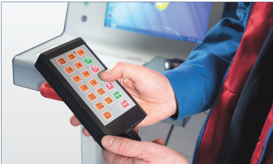
Handsteuergerät zum schnellen Einrichten der Maschine
