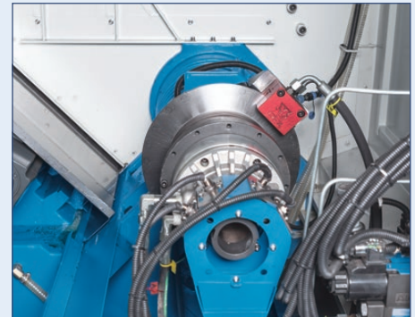
Spindelbohrung mit Zugrohr bis 75 mm (Roturn 402M)
