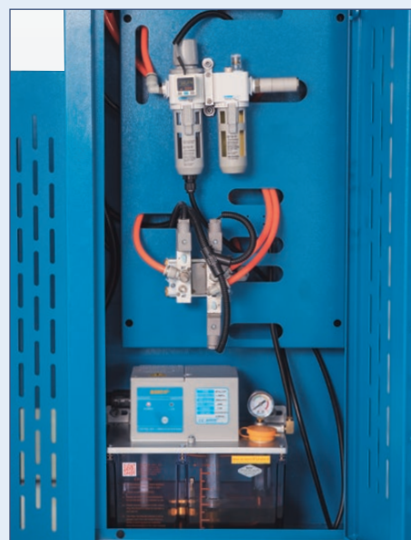
Die automatische Zentralschmierung erleichtert die Wartung der Maschine
