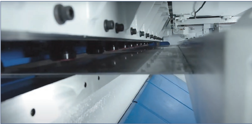
Standard Ober- und Untermesser für Edelstahlbleche
