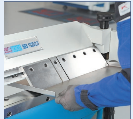
Das segmentierte Oberwerkzeug ermöglicht die Bearbeitung von Kastenprofilen in unterschiedlichen Seitenlängen
