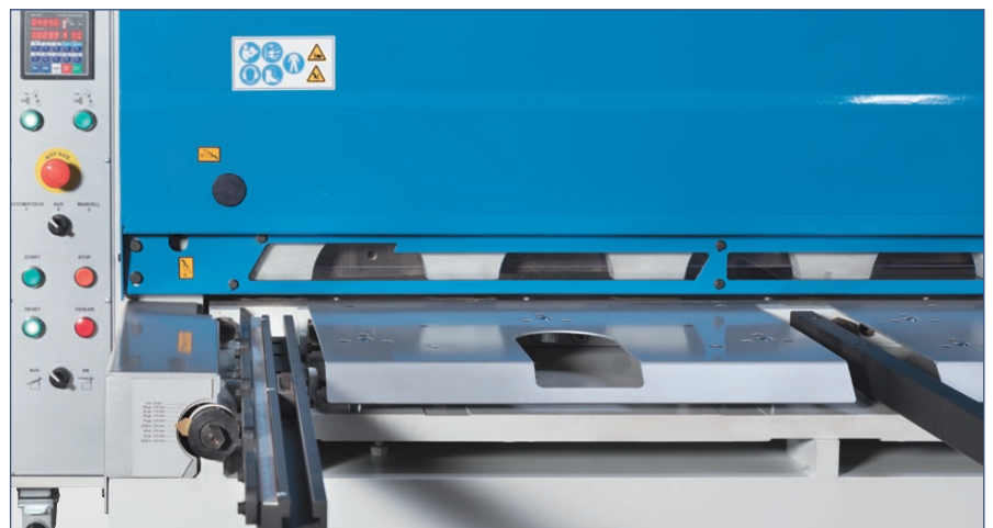
Seitenanschlag mit Skalierung und manuell einstellbarer Schnittpaltverstellung
