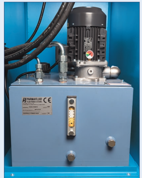
Das Hydrauliksystem ist platzsparend aber gut zugänglich im Gestell eingebaut
