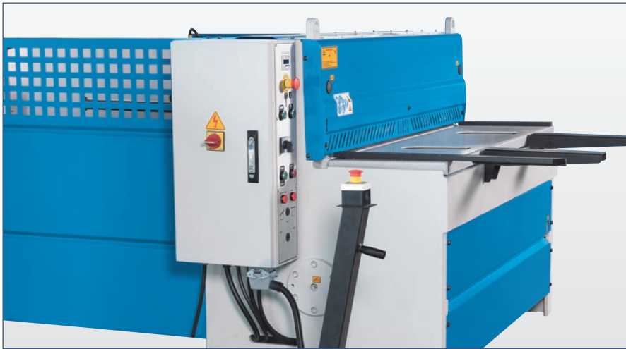
Durch stabile Verkleidung und Lichtvorhang gesicherter Hinteranschlag
