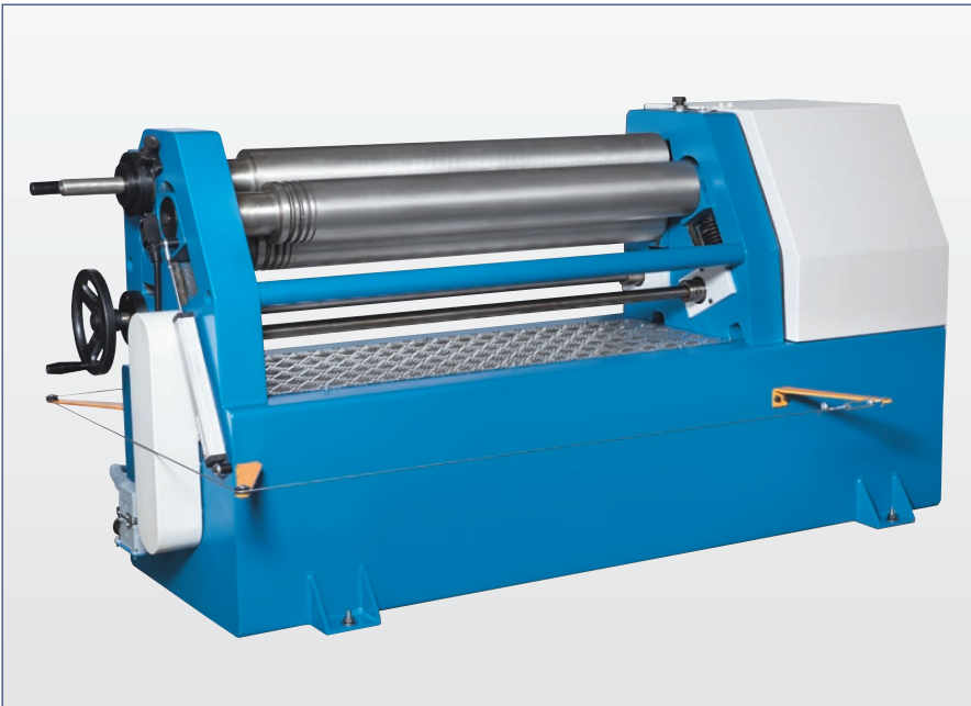
Die Hinterwalze kann optional mit einer motorischen Zustellung und digitaler Anzeige ausgerüstet werden
