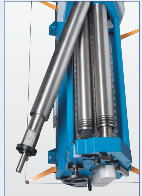
Zur Entnahme des fertig gerundeten Werkstückes kann die Oberwalze ausgeschwenkt werden
