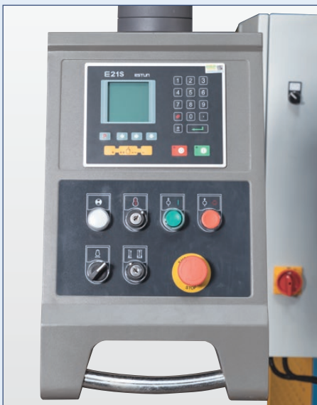
NC-Steuerung für schnelles Positionieren des Hinteranschlages
