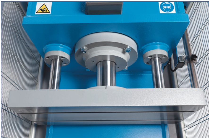
Zwei Rundführungen gewährleisten die Parallelität der Stößelplatte während der Hubbewegung
