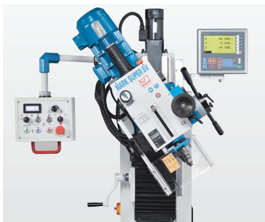
Kopf schwenkbar um \pm 45^\circ
