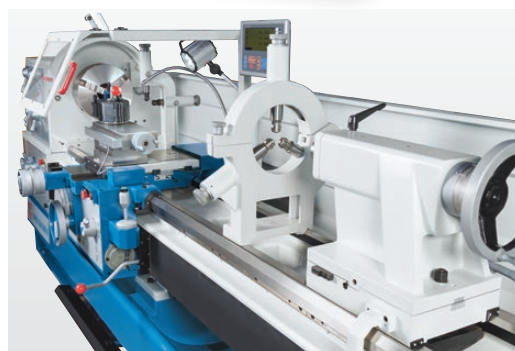
Lünetten zur präzisen Bebearbeitung langer Werkstücke
