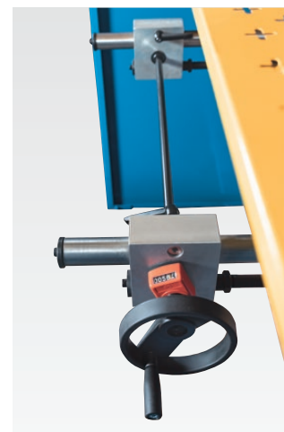
Manueller Hinteranschlag mit mechanisch-digitaler Positionsanzeige
