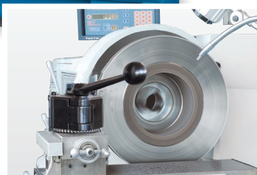
Konstante Schnittgeschwindigkeit für eine perfekte Oberfläche
