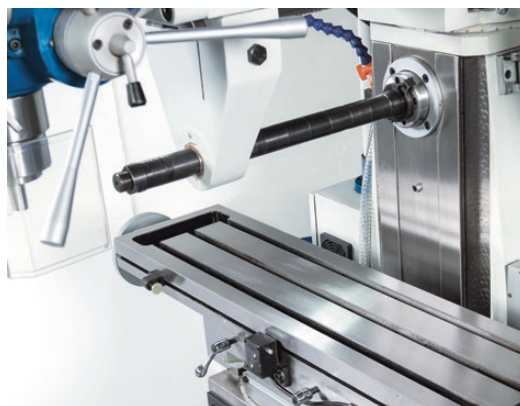
Der solide Oberbalken mit Gegenhalter ermöglicht die stabile Aufnahme langer Fräsdorne
