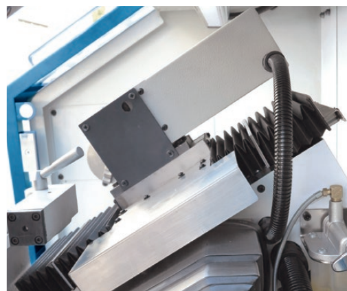
Schrägbettbauweise für optimierten Arbeitsraum und Späneabfuhr
