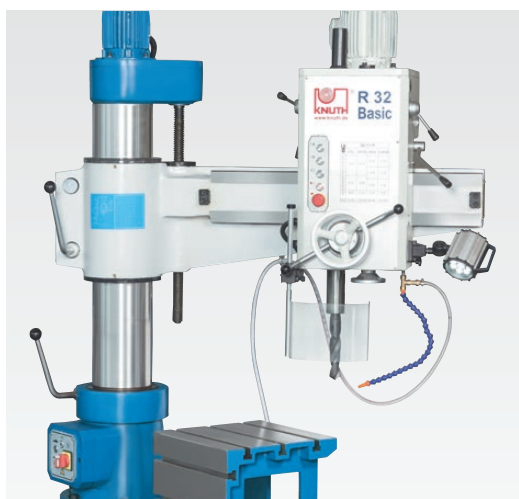
Schwenkbarer Ausleger mit großer Ausladung
