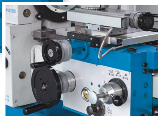
Wartungsfreundlichkeit und einfache Handhabung gewährleistet die im Support integrierte Zentralschmierung
