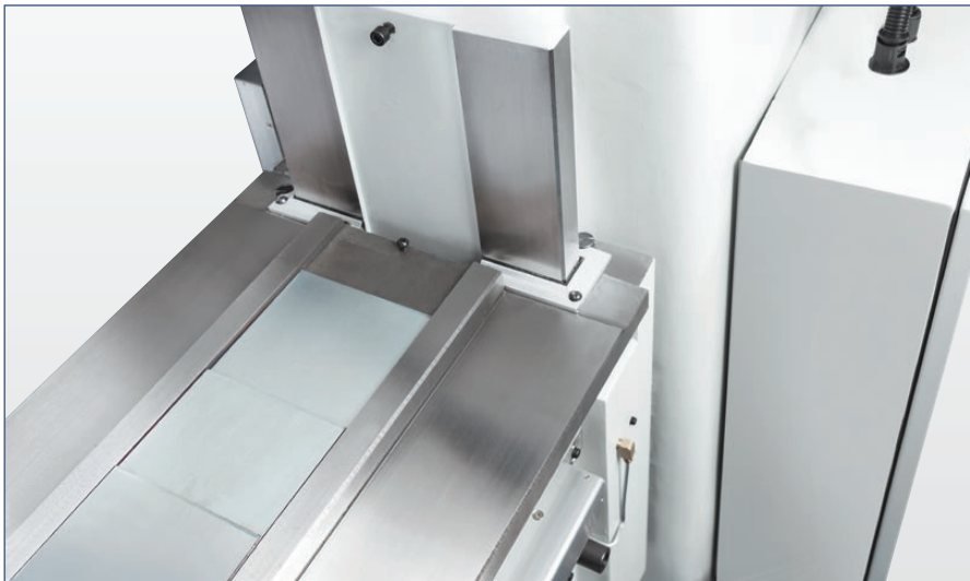
Breite, stabile Flachführungen in Z- und Y-Achse
