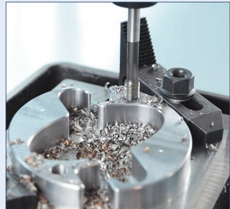
Der Gewindeschneidmodus kann über das Bedienfeld ausgewählt werden
