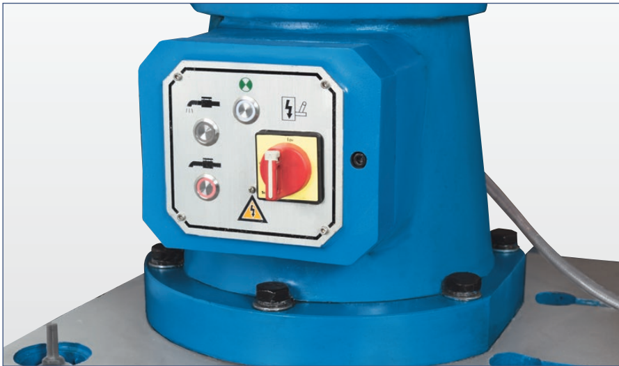
Stabiler Säulenfuß mit zentralem Hauptschalter
