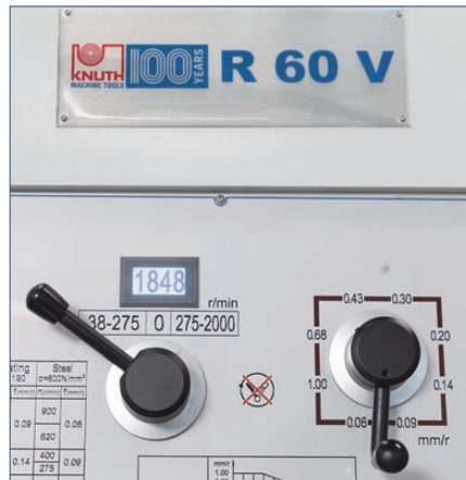
Stufenlos regelbare Spindeldrehzahl mit Vorlege, über eine Digitalanzeige gut ablesbar
