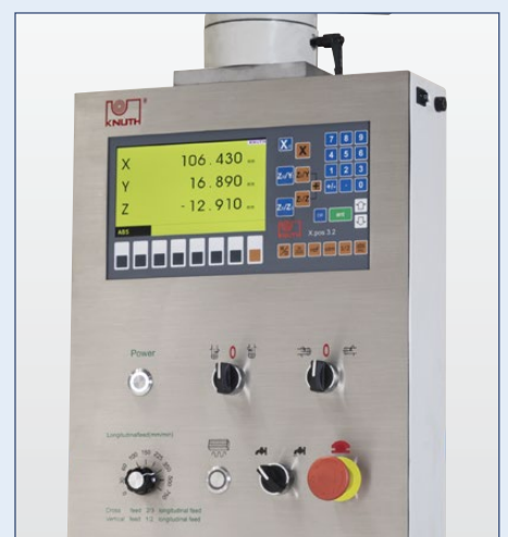
Schwenkbares Bedienpult mit integrierter Positionsanzeige
