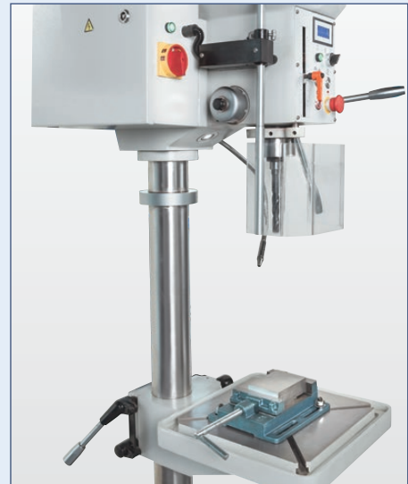
Der Bohrtisch wird über eine doppelte Klemmung fest fixiert
