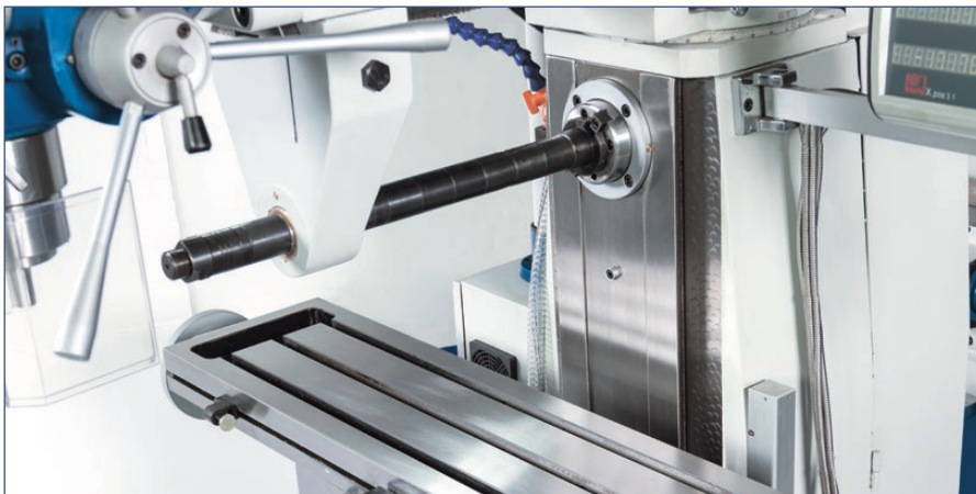
Der solide Oberbalken mit Gegenhalter ermöglicht die stabile Aufnahme langer Fräsdorne
