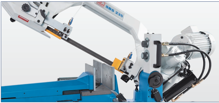
Stabile verstellbare Führungen ermöglichen präzise Schnitte
