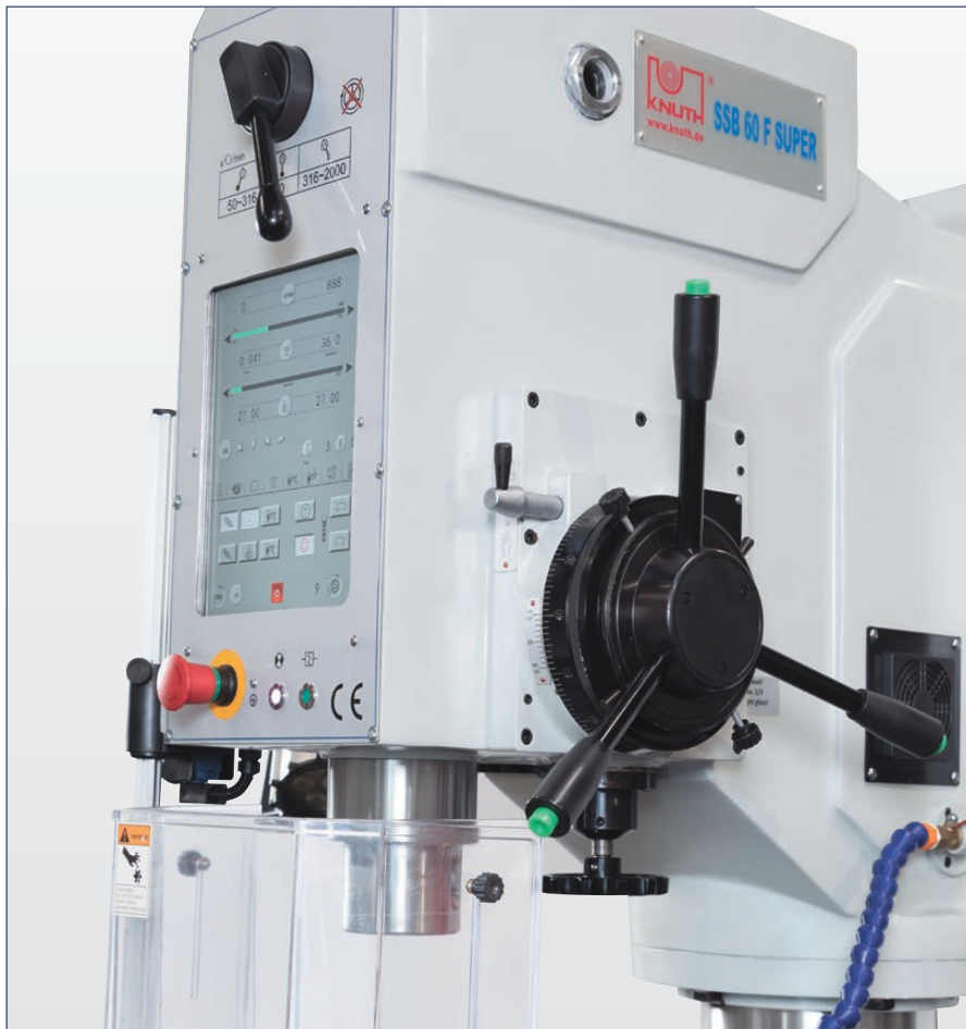
Elektronisch geregelter Servo-Pinolenvorschub mit Gewindeschneidfunktion
