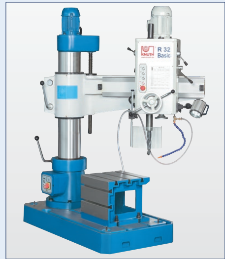
Schwenkbarer Ausleger mit großer Ausladung
