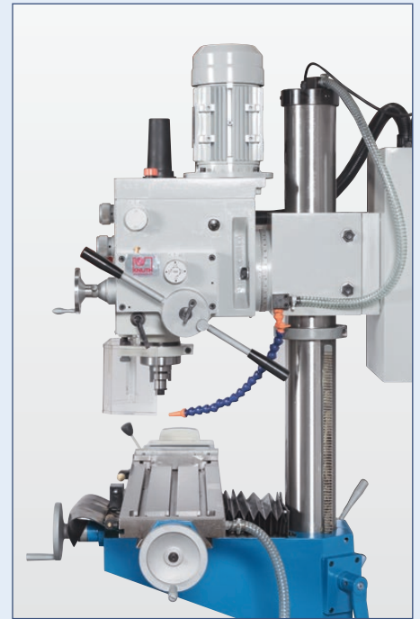
Automatischer Pinolenvorschub mit 3-Stufengetriebe
