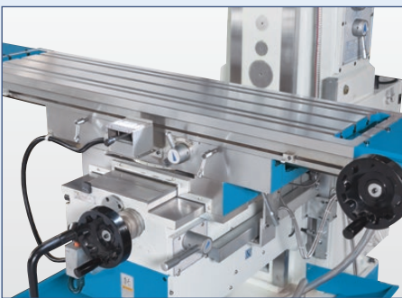
Groß dimensionierte Rechteckführungsbahnen ermöglichen Präzision und Laufruhe
