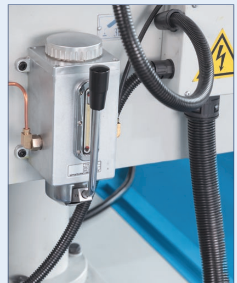
Die Zentralschmierung erleichtert die Wartung der Maschine
