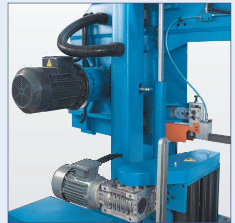
Die kraftvollen Motoren für Sägeblatt- und Vorschubantrieb sind mit Getrieben kombiniert, die den hohen Anforderungen in jeder Hinsicht gewachsen sind, geräuscharm, hoch belastbar und raumsparend
