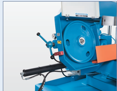
Ein Manometer garantiert die richtige Sägeblattspannung
