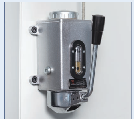
Eine Zentralschmierung versorgt die Säule zuverlässig mit Schmiermittel
