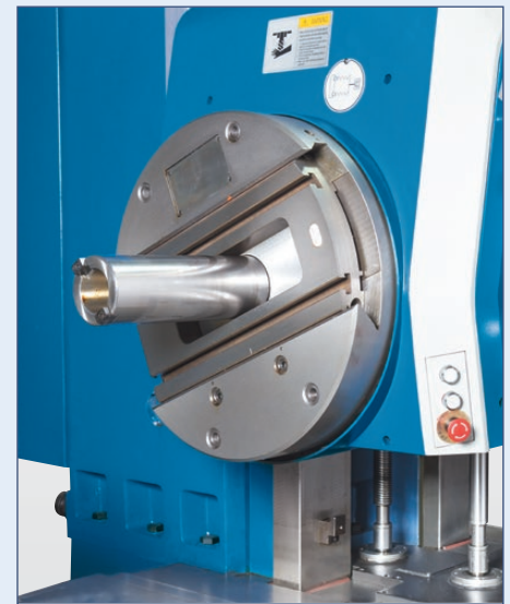
Der Planschieber verfügt über einen langen Hub zum Ausdrehen
