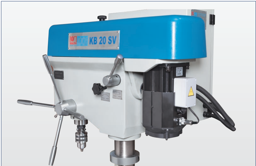
AC-Servomotoren liefern bei niedrigen Drehzahlen ein hohes Drehmoment
