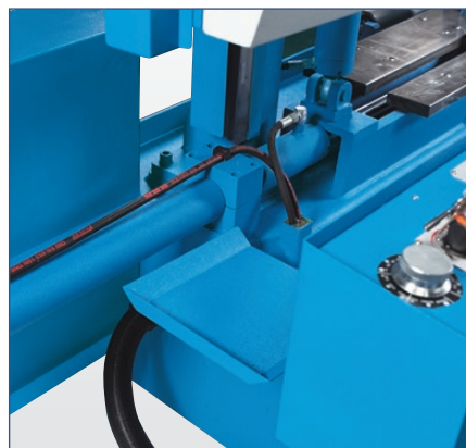
Hydraulische Werkzeugspannung bei allen Modellen serienmäßig
