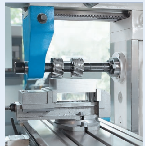
Die Horizontalspindel ermöglicht eine effiziente Zerspänung
