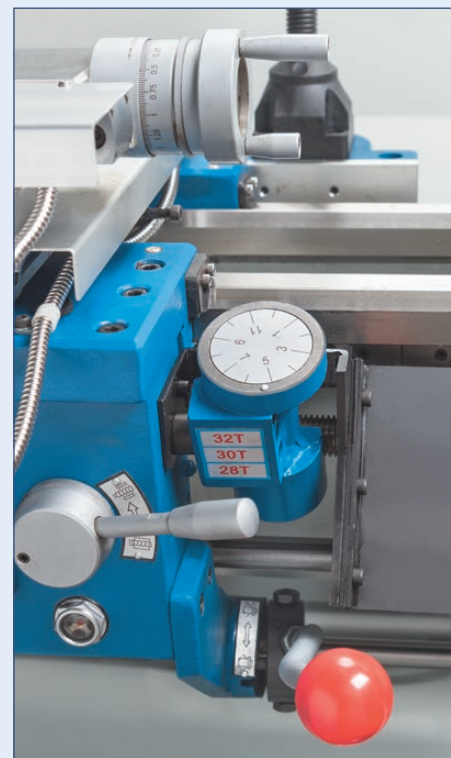
Die Gewindeuhr gewährleistet die Wiederaufnahme des Gewindegangs, nachdem die Schlossmutter für die rückläufige Bewegung geöffnet wurde
