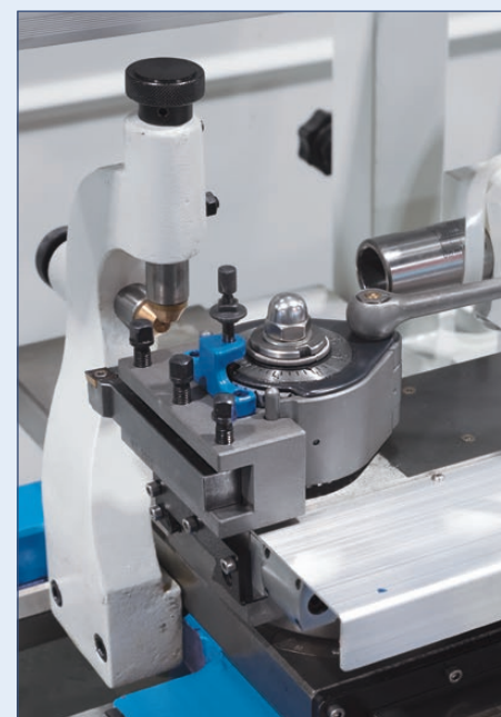
Im Schnellwechselstahlhaltersystem sind Drehmeißel schnell einsatzbereit
