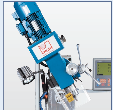
Schwenkbarer Fräskopf mit verfahrbarer Pinole
