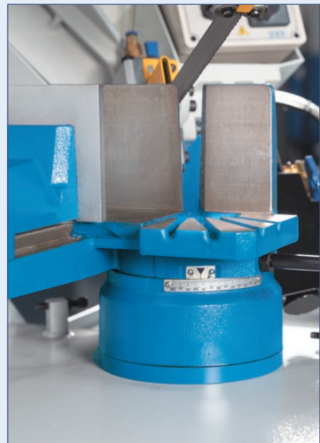
Die Skalierung ermöglicht die exakte Winkelpositionierung
