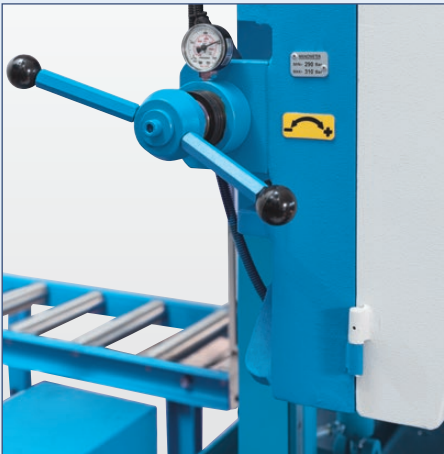
Manometer für korrekte Sägeblattspannung
