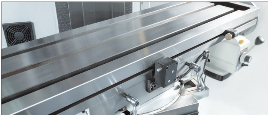
In der X-Achse schwenkbarer Frästisch
