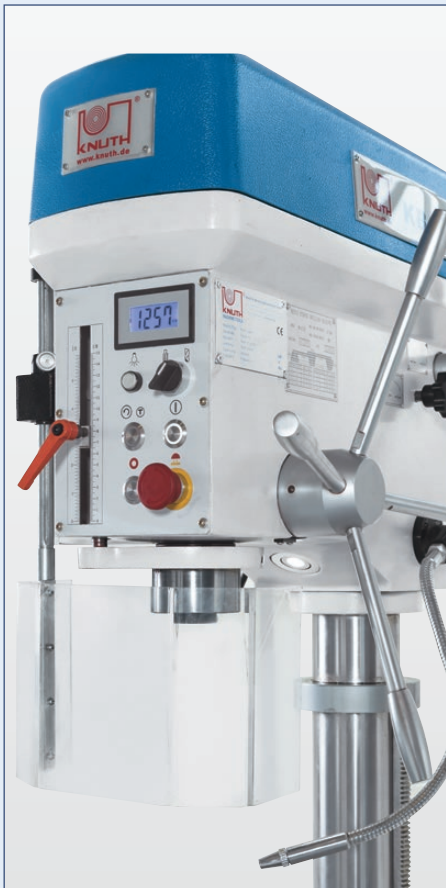
Digitale Drehzahlanzeige und integrierte Arbeitsleuchte serienmäßig
