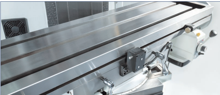
In der X-Achse schwenkbarer Frästisch
