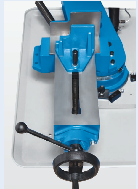
Der Schraubstock bietet eine große Spannweite
