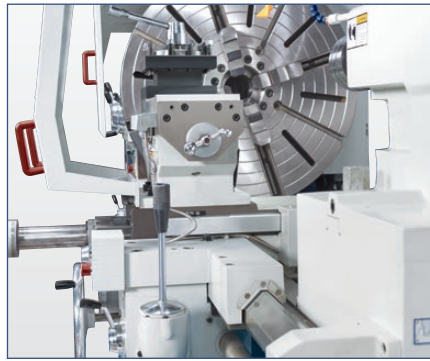
Support und Oberschlitten sind für große Schnittkräfte ausgelegt
