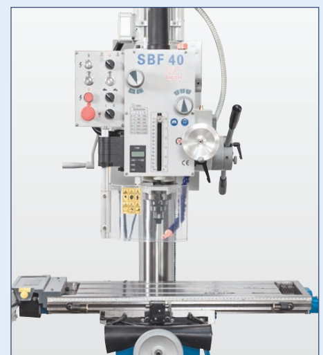
Der Getriebekopf ist beidseitig schwenkbar
