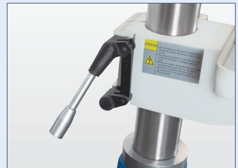
Doppelte Tischklemmung garantiert Stabilität
