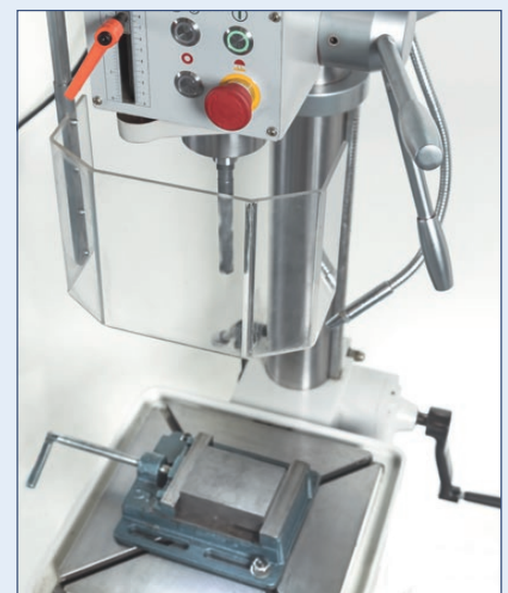
Großer quadratischer Arbeitstisch mit diagonalen Spannuten
