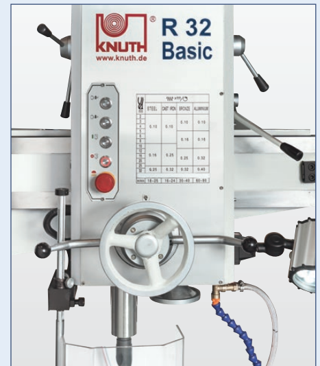
Die Handhebel für den Pinolenvorschub schalten den automatischen Vorschub
