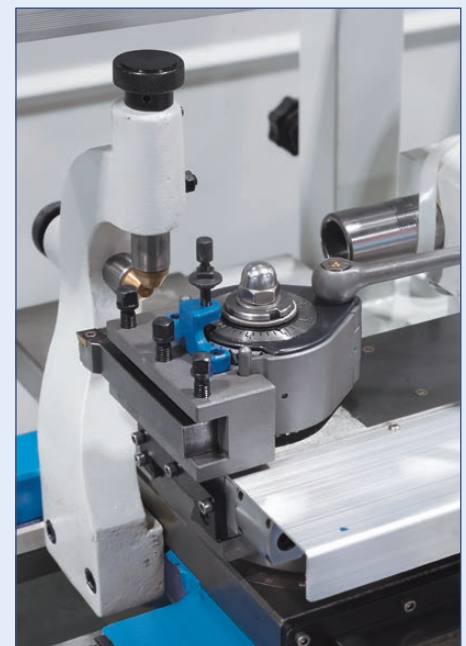
Im Schnellwechselstahlhaltersystem sind Drehmeißel schnell einsatzbereit
