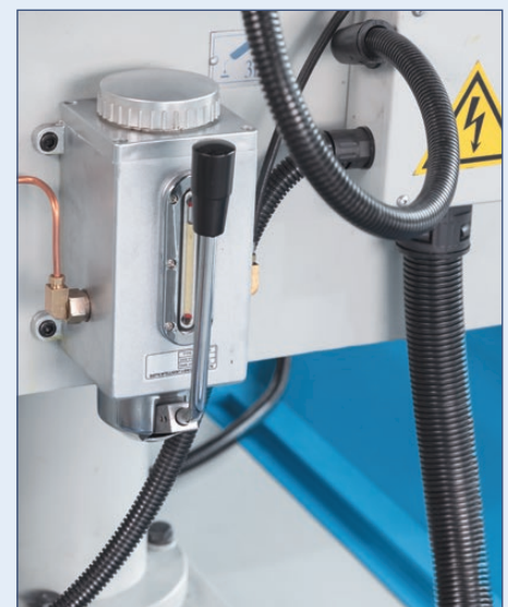
Die Zentralschmierung erleichtert die Wartung der Maschine
