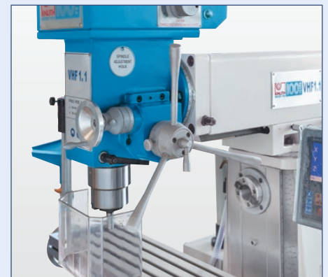
Ein Handrad für die Feineinstellung ermöglicht die exakte Positionierung der Pinole
