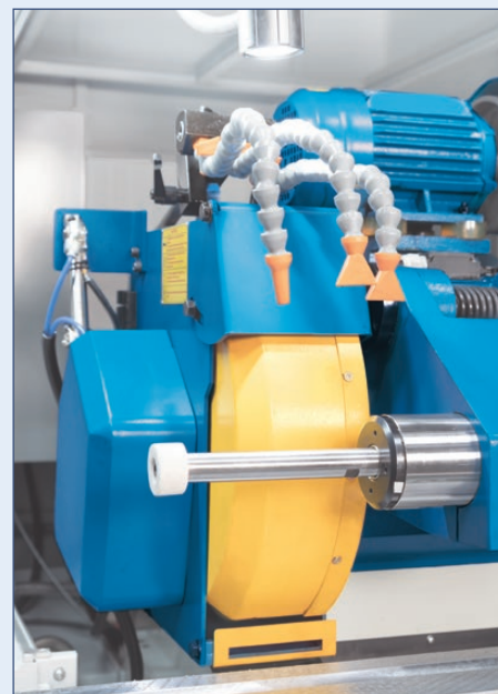
Die Innenschleifeinrichtung wird bei Bedarf in den Arbeitsbereich geschwenkt
