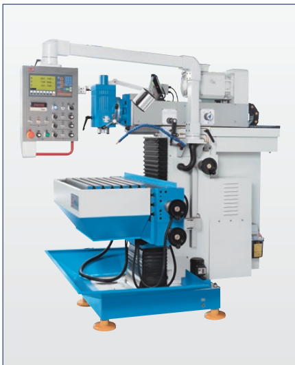
Alle Bedienelemente sind auf einer Seite konzentriert
