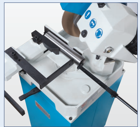
Stabile Werkstückklemmung mit zusätzlicher Fixierung des Abschnitts
