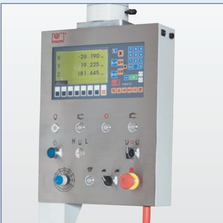
Schwenkbares Bedienpult für eine komfortable Bedienung
