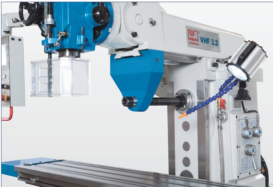
Lange Fräsdorne werden vom soliden Gegenhalter geführt
