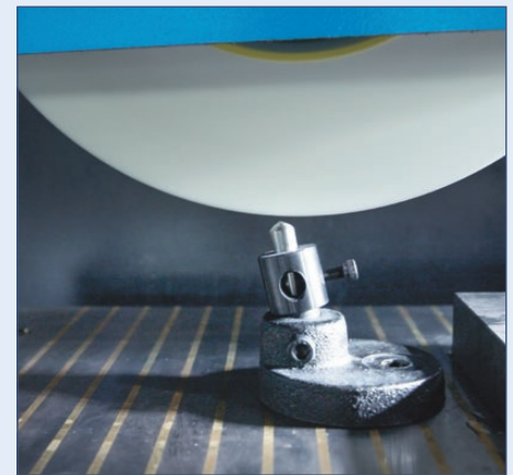
Mit dem Abrichten wird ein genauer Rundlauf und eine korrekte geometrische Form der Schleifscheibe erreicht
