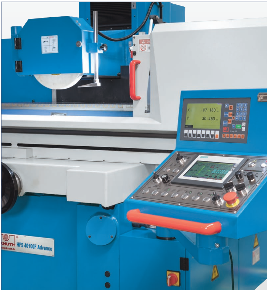
Alle notwendigen Parameter für die präzise Zustellung der Schleifspindel werden direkt am Siemens-Touchscreen erfasst und editiert
