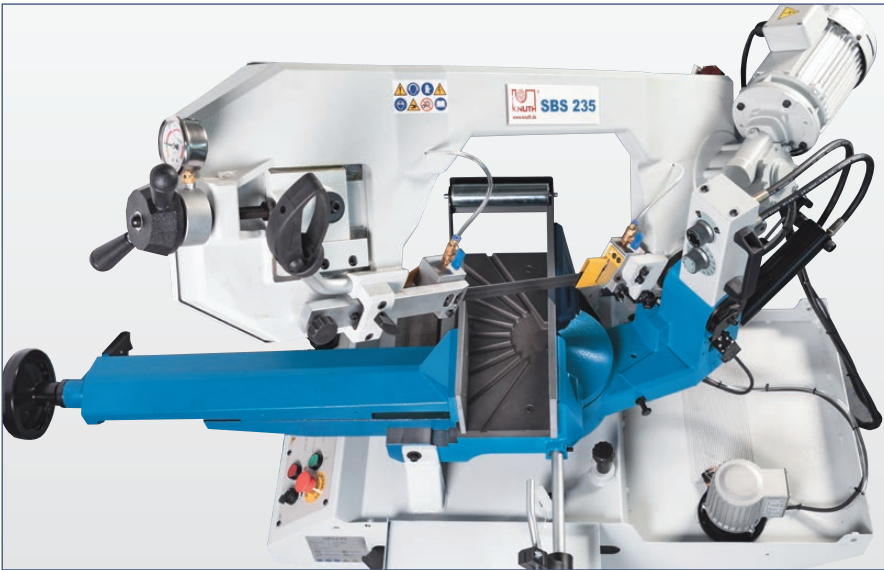
Großer Schwenkbereich für Gehrungsschnitte rechts und links
