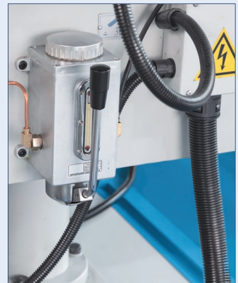
Die Zentralschmierung erleichtert die Wartung der Maschine
