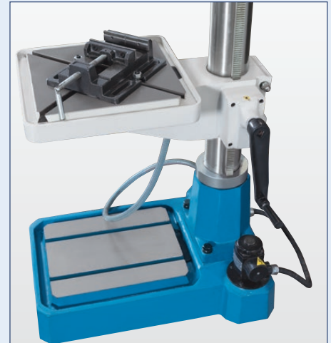
Kühlmitteleinrichtung in der Maschinenbasis integriert
