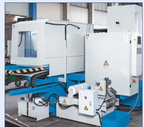
Bei der Fahrständerbauweise läuft der Schleiftisch direkt auf dem breiten Maschinenbett
