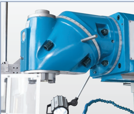
In 2 Ebenen schwenkbarer Universalfräskopf
