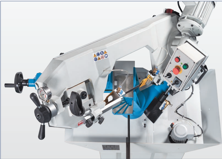
Der Sägebügel ist bis 60° schwenkbar
