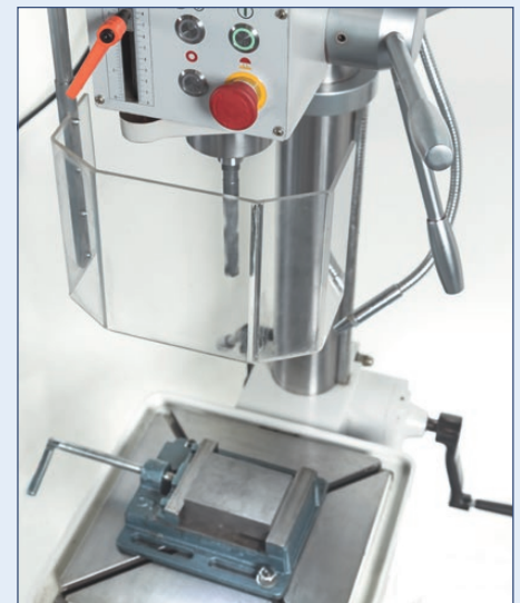
Großer quadratischer Arbeitstisch mit diagonalen Spannuten
