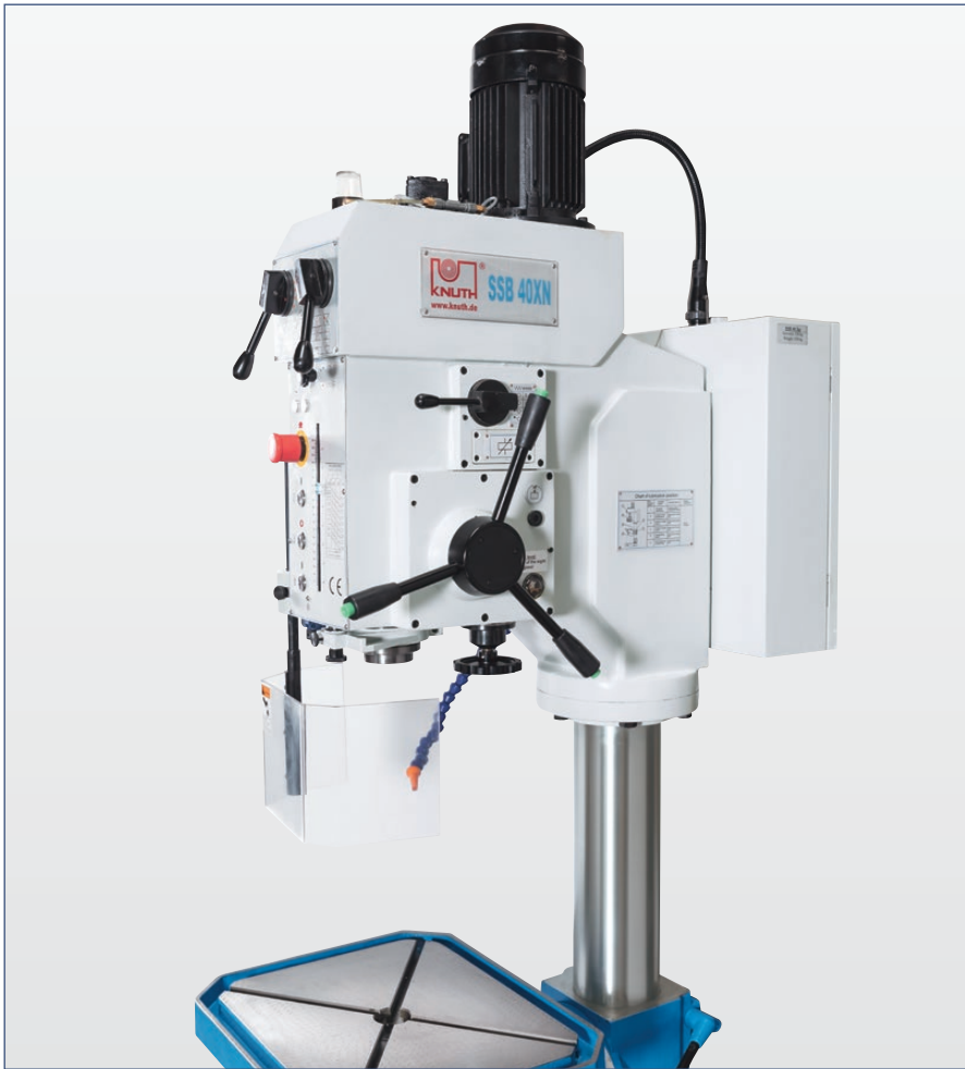
Das 3-stufige, im Bohrkopf integrierte Vorschubgetriebe läuft wartungsarm im Ölbad und ist leicht schaltbar
