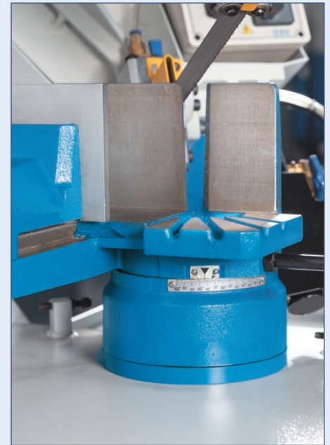
Die Skalierung ermöglicht die exakte Winkelpositionierung
