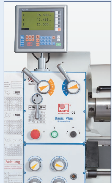
Positionsanzeige für X-, Z- und Z1-Achse
