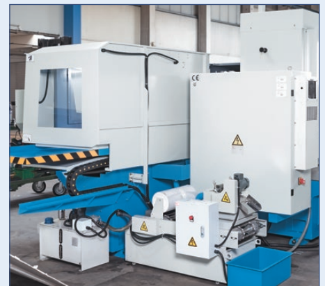
Bei der Fahrständerbauweise läuft der Schleiftisch direkt auf dem breiten Maschinenbett
