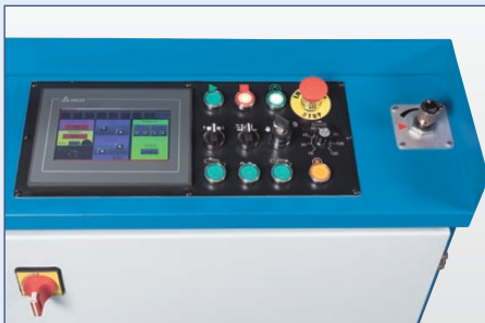
SPS-Steuerung mit Touchscreen
