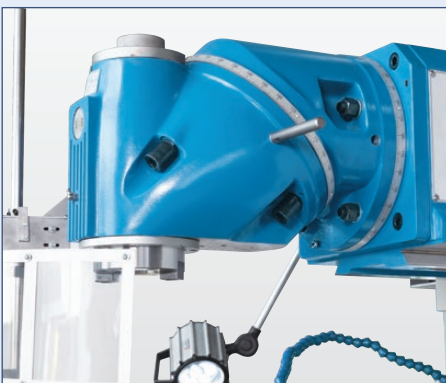
In 2 Ebenen schwenkbarer Universalfräskopf
