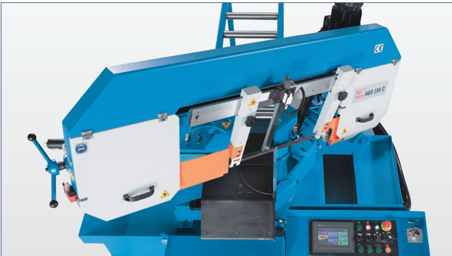
Der Sägebügel kann bis zu 45° geschwenkt werden
