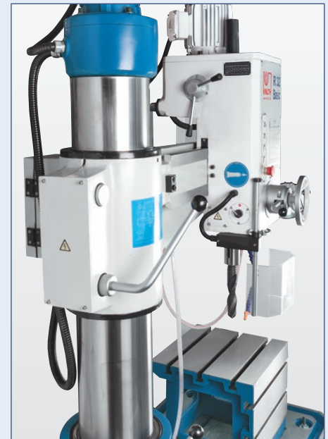
Mechanische Kopf-, Säulen- und Armklemmung liegen gut in der Hand
