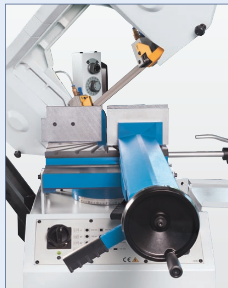
Der manuelle Schraubstock der SBS 235/255 verfügt über eine Schnellspannfunktion
