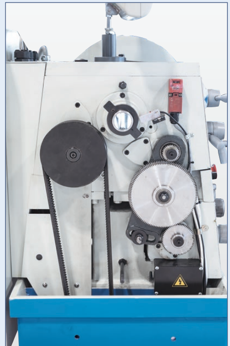
Wechselräder ermöglichen ein breites Spektrum unterschiedlicher Gewindesteigungen und Vorschübe
