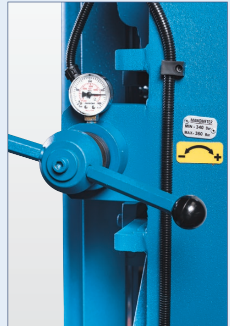
Manometeranzeige für die korrekte Sägeblattspannung - erhöht die Standzeit und senkt die Kosten
