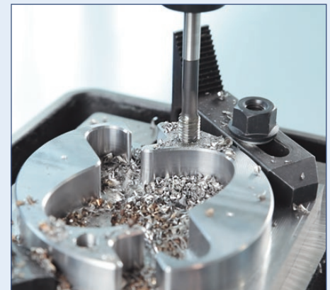
Der Gewindeschneidmodus kann über das Bedienfeld ausgewählt werden
