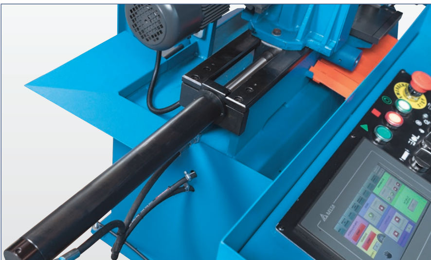
Hydraulische Werkstückklemmung serienmäßig
