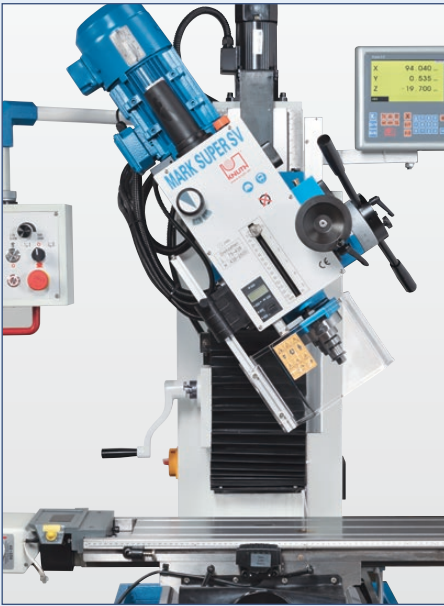
Getriebekopf ist beidseitig schwenkbar
