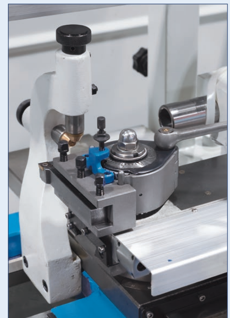
Im Schnellwechselstahlhaltersystem sind Drehmeißel schnell einsatzbereit
