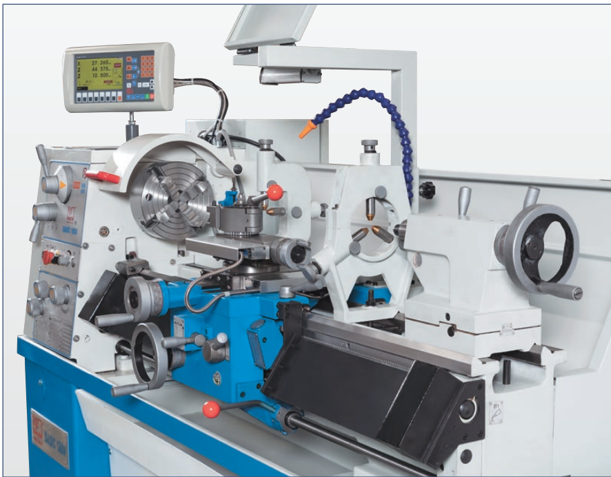
Umfangreiche Serienausstattung: Positionsanzeige, Lünetten, Schnellwechselstahlhalter und vieles mehr
