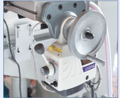
Automatischer Vorschub und Eilgang, stufenlos regelbar und mit einstellbaren Endanschlägen
