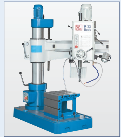
Schwenkbarer Ausleger mit großer Ausladung
