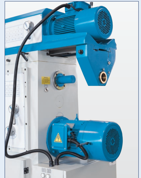
Horizontalspindel mit eigenem Antrieb und feinstufigem Schaltgetriebe
