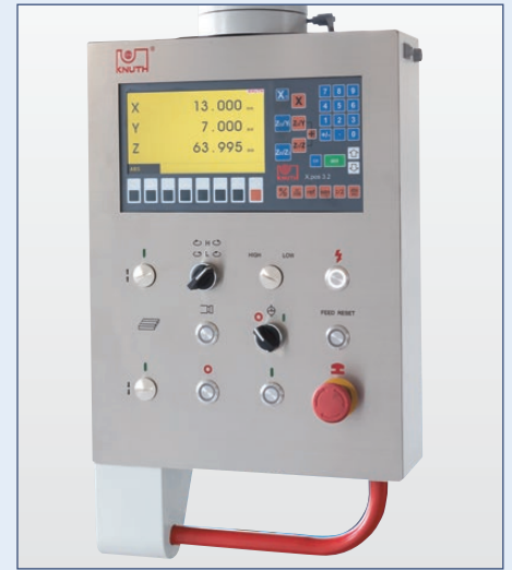
Das intuitive Bedienfeld ist durch den Ausleger nach Bedarf positionierbar
