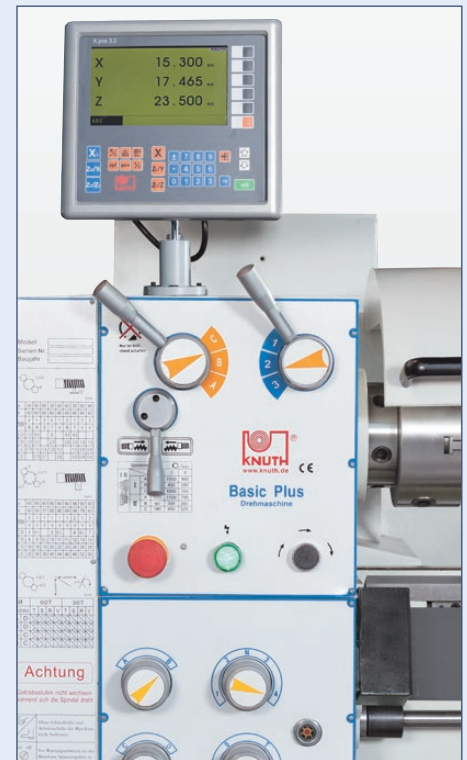
Positionsanzeige für X-, Z- und Z1-Achse
