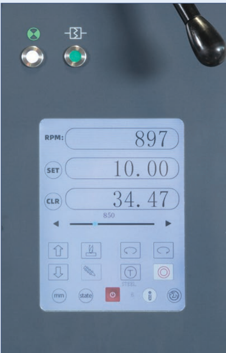
Bohrmaschine 2.0- alle Funktionen auf einem robusten Touchscreen
