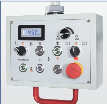
Übersichtliches und intuitives Bedienfeld mit Drehzahlanzeige
