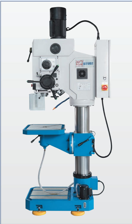
Große Ausladung und schwenk- und drehbarer Arbeitstisch
