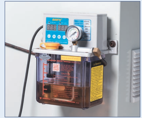
Kontinuierliche und präzise Schmierung minimiert Reibung und Verschleiß beweglicher Teile u. erhöht die Lebensdauer der Maschine
