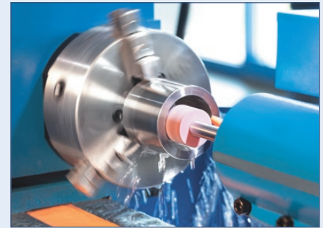
Der maximale Innenschleifdurchmesser beträgt 100 mm
