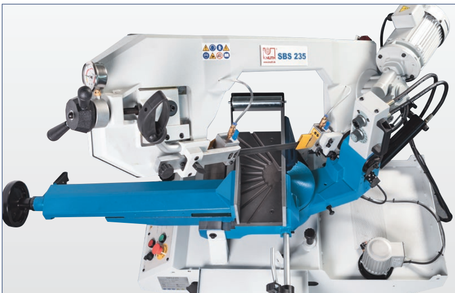
Großer Schwenkbereich für Gehrungsschnitte rechts und links
