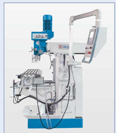
Vertikal- und Horizontalspindel verfügen jeweils über einen separaten Antrieb
