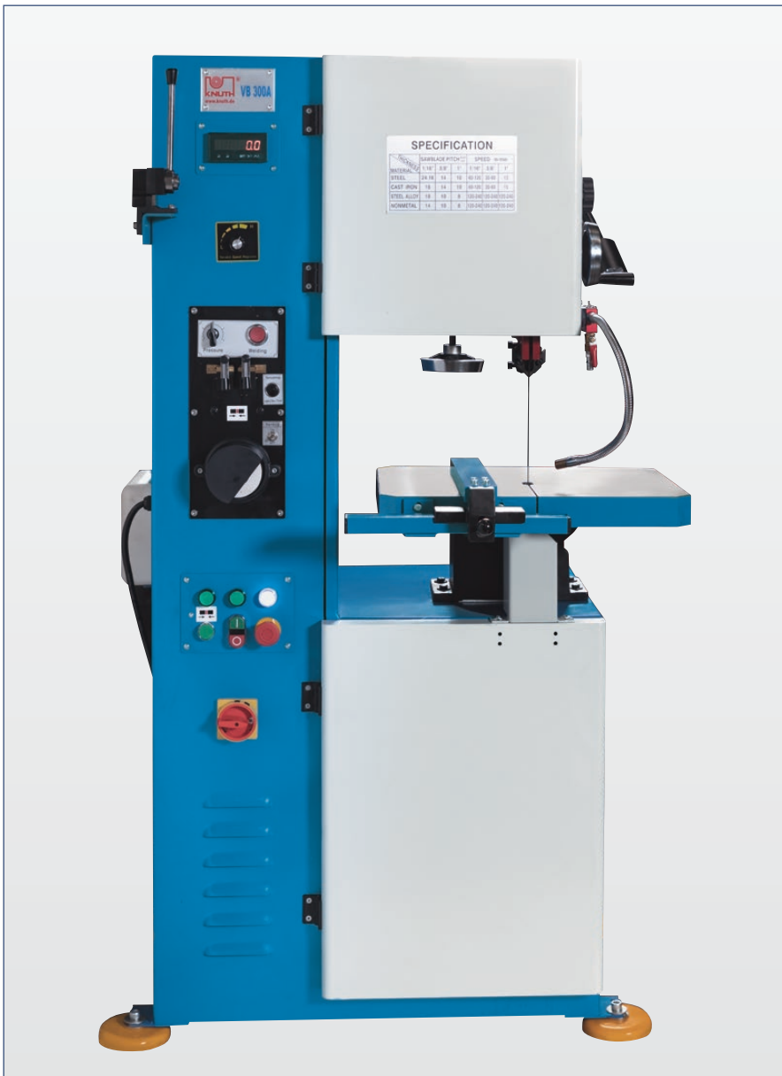
Sägeblattschweißapparat mit Ausglühvorrichtung, Sägeblattschere und Schleifstein zum Trennen und Zusammenfügen des Sägeblattes bei der Bearbeitung geschlossener Innenkonturen
