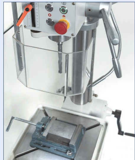
Großer quadratischer Arbeitstisch mit diagonalen Spannuten
