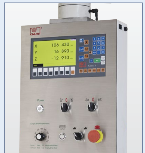
Schwenkbares Bedienpult mit integrierter Positionsanzeige
