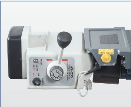
Stufenlos regelbarer Frästischvorschub
