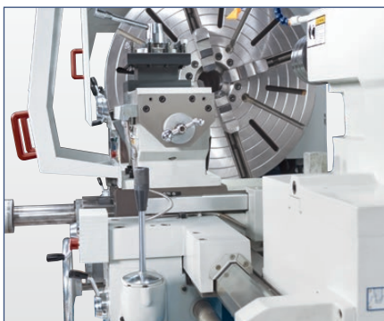
Support und Oberschlitten sind für große Schnittkräfte ausgelegt
