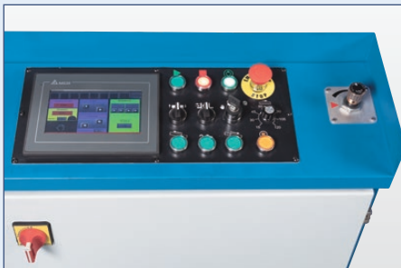
SPS-Steuerung mit Touchscreen
