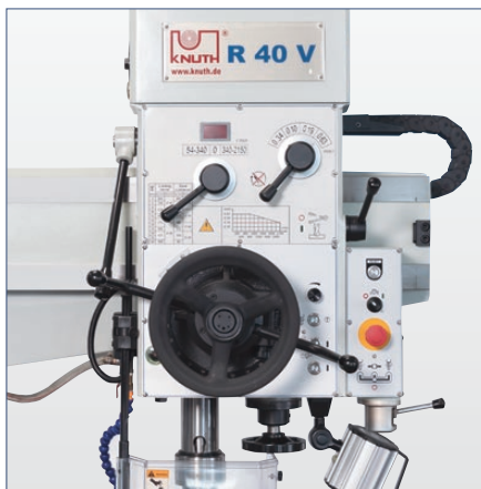
Einstellbarer Bohrtiefenanschlag mit großer, gut ablesbarer Skalierung und Nonius
