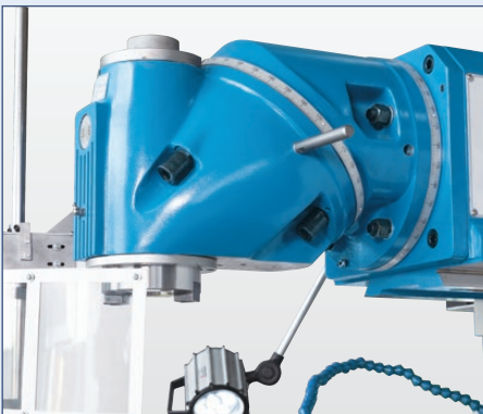
In 2 Ebenen schwenkbarer Universalfräskopf
