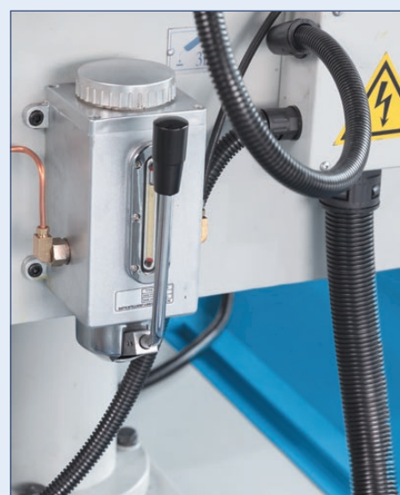
Die Zentralschmierung erleichtert die Wartung der Maschine
