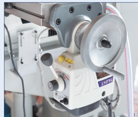
Automatischer Vorschub und Eilgang, stufenlos regelbar und mit einstellbaren Endanschlägen
