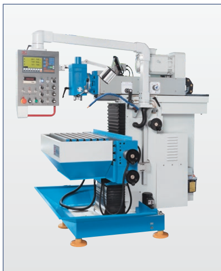
Alle Bedienelemente sind auf einer Seite konzentriert
