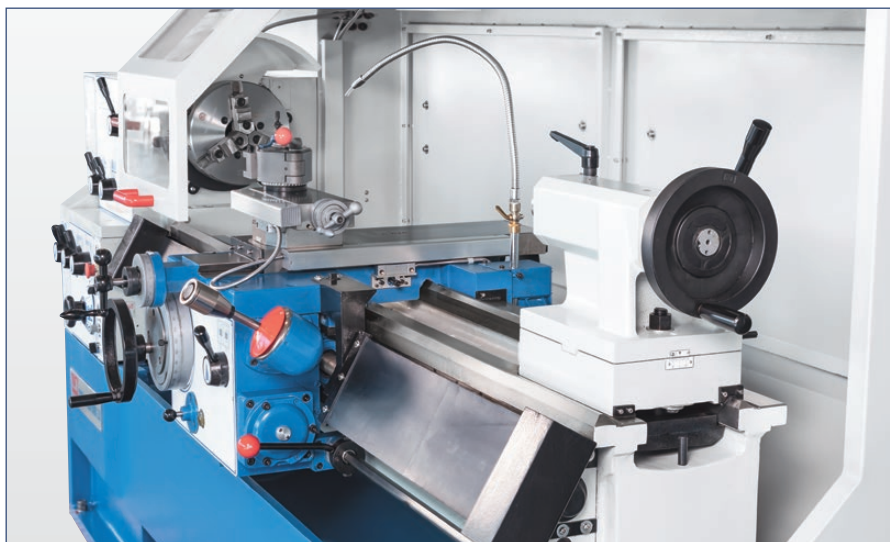
Der Reitstock kann zum Kegeldrehen seitlich justiert werden
