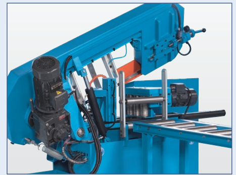
Der stufenlos drehzahlregelbare Motor überträgt seine Kraft über ein für den Dauerbetrieb ausgelegtes Umlenkgetriebe auf das Antriebsrad der Maschine
