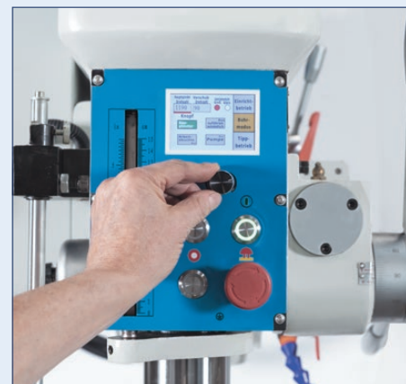
Spindeldrehzahl stufenlos regelbar
