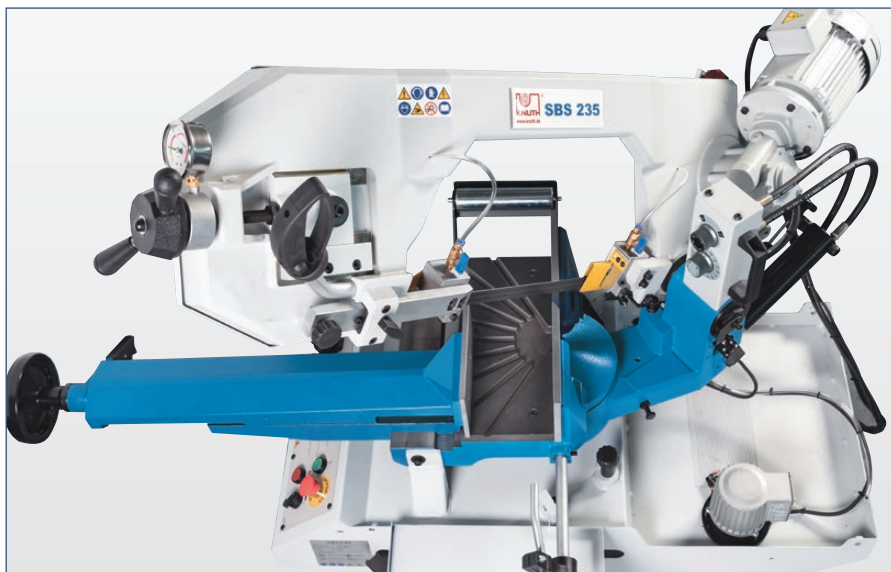
Großer Schwenkbereich für Gehrungsschnitte rechts und links
