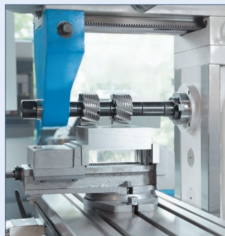
Die Horizontalspindel ermöglicht eine effiziente Zerspänung
