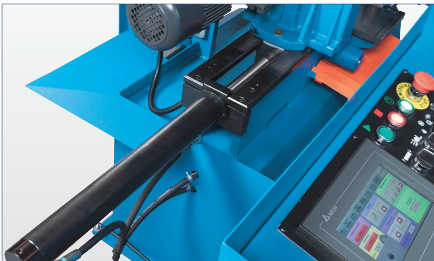
Hydraulische Werkstückklemmung serienmäßig
