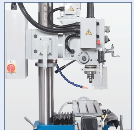
Getriebekopf und Tisch sind höhenverstellbar
