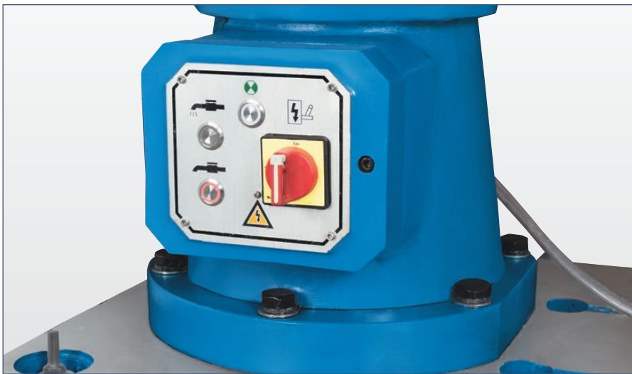
Stabiler Säulenfuß mit zentralem Hauptschalter
