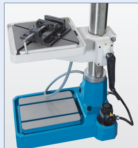
Kühlmitteleinrichtung in der Maschinenbasis integriert
