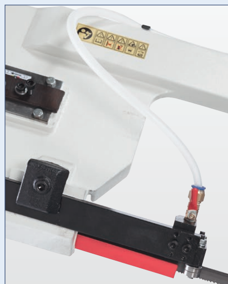
Stabile, einstellbare Sägebandführungen
