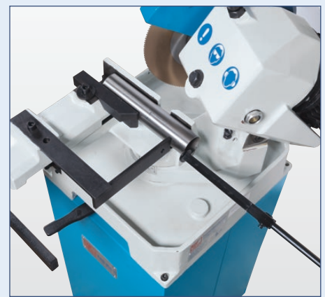
Stabile Werkstückklemmung mit zusätzlicher Fixierung des Abschnitts
