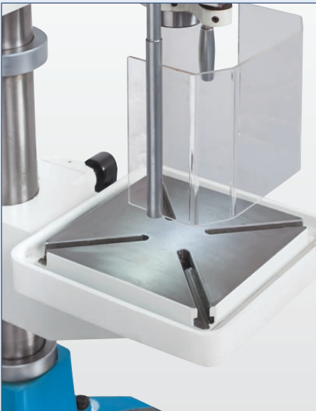
Großer quadratischer Arbeitstisch mit diagonalen Spannuten
