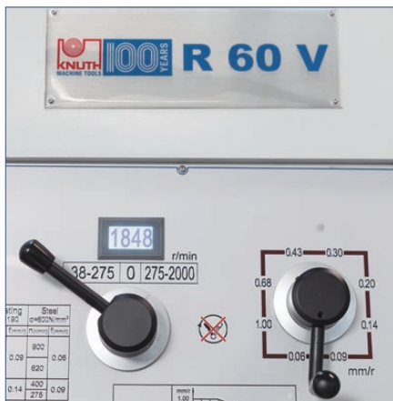
Stufenlos regelbare Spindeldrehzahl mit Vorlege, über eine Digitalanzeige gut ablesbar
