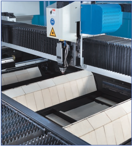
Schamottplatten schützen das Maschinengestell effektiv vor thermischen Schäden
