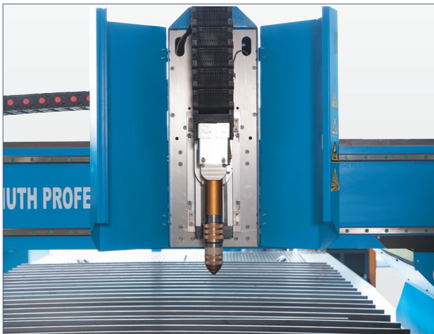
Plasmapbrenner mit Schnellkupplung verkürzen die Rüstzeiten und erhöhen die Sicherheit
