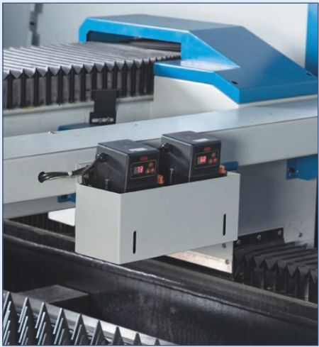
Zentralschmierung: minimierter Wartungsaufwand, erhöhte Zuverlässigkeit
