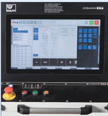
Leistungsstarke Eckelmann CNC-Einheit mit 19" Touchscreen von ELO
