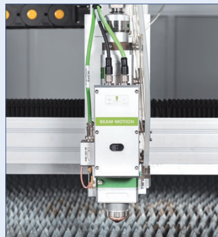
Schneidkopf mit integriertem Kollisionsschutz, automatischer Fokuslagenverstellung und Höhenkontrolle
