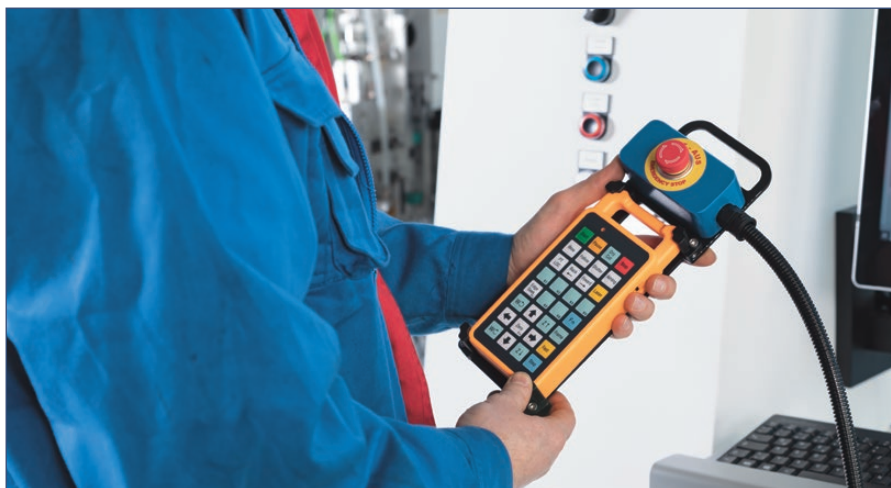
Handbediengerät erleichtert das Einrichten der Maschine
