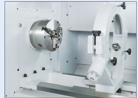
Option: feste Lünette bis zu 400 mm Durchmesser
