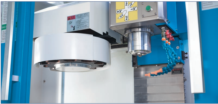
Der 12-fach Werkzeugwechsler erhöht die Produktivität, Flexibilität und Sicherheit bei der Bearbeitung
