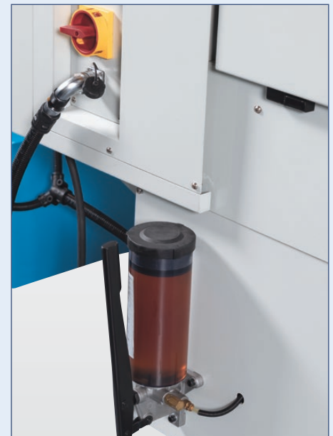
Die Zentralschmierung erleichtert die Wartung
