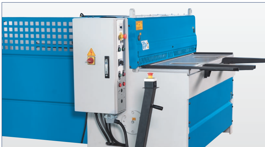
Durch stabile Verkleidung und Lichtvorhang gesicherter Hinteranschlag
