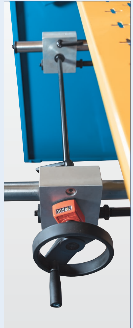
Manueller Hinteranschlag mit mechanisch-digitaler Positionsanzeige
