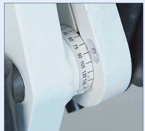
Ein Winkelanschlag stellt sicher, dass jedes Werkstück mit den gleichen Einstellungen gebogen wird
