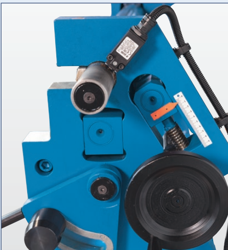
Die Hinterwalzenzustellung erfolgt manuell oder optional motorisch
