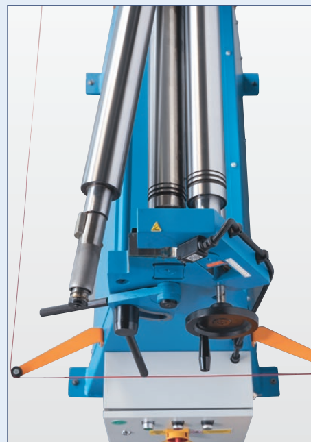
Zur Entnahme des fertigen, gerundeten Werkstücks kann die Oberwalze ausgeschwenkt werden
