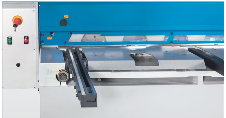
Seitenanschlag mit Skalierung und manuell einstellbarer Schnittpaltverstellung
