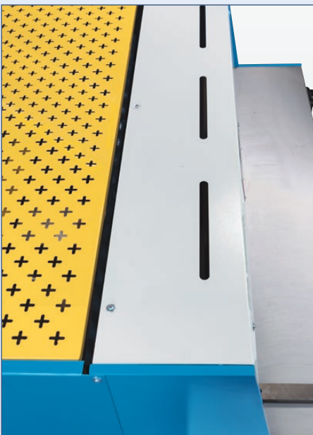
Die Schnittlinienbeleuchtung macht den Anriss gut sichtbar
