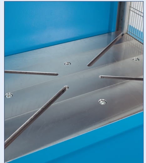
Diagonal ausgerichtete Nuten erleichtern die mittenzentrierte Aufspannung der Werkzeuge
