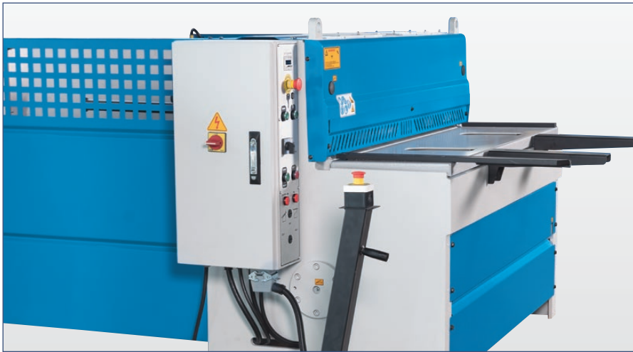
Durch stabile Verkleidung und Lichtvorhang gesicherter Hinteranschlag
