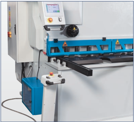
Die mobile Bedieneinheit steigert sowohl die Sicherheit als auch die Effizienz der Arbeit
