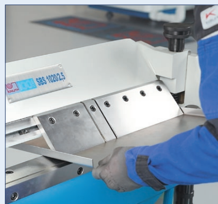
Das segmentierte Oberwerkzeug ermöglicht die Bearbeitung von Kastenprofilen in unterschiedlichen Seitenlängen
