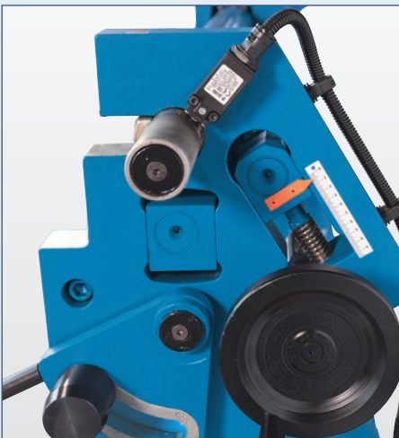
Die Hinterwalzenzustellung erfolgt manuell oder optional motorisch
