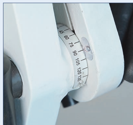
Ein Winkelanschlag stellt sicher, dass jedes Werkstück mit den gleichen Einstellungen gebogen wird
