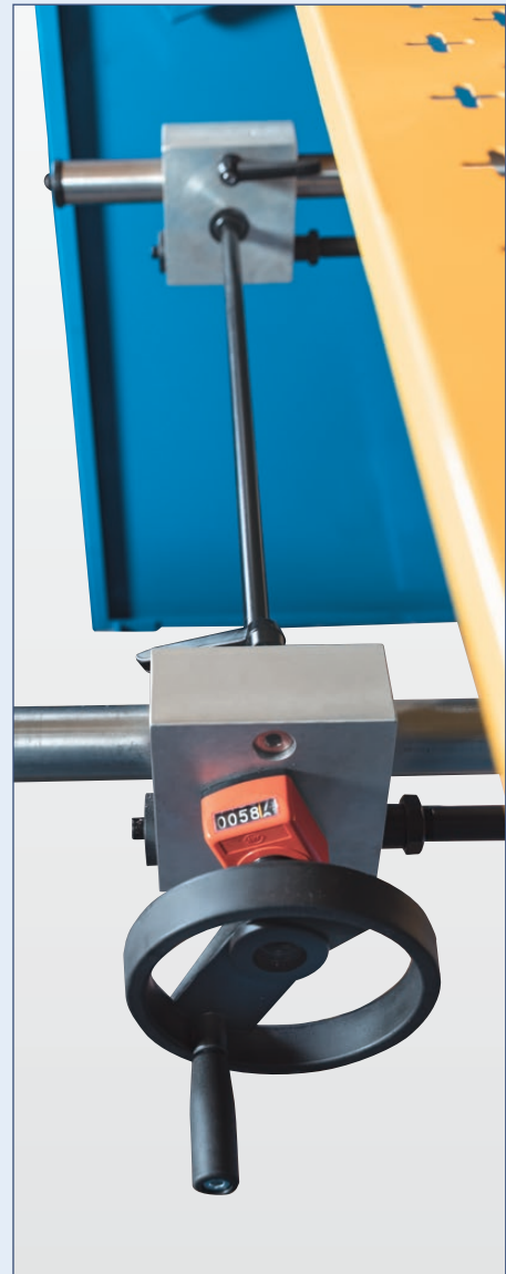
Manueller Hinteranschlag mit mechanisch-digitaler Positionsanzeige
