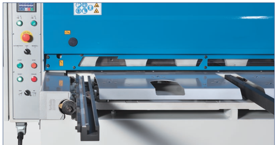
Seitenanschlag mit Skalierung und manuell einstellbarer Schnittpaltverstellung
