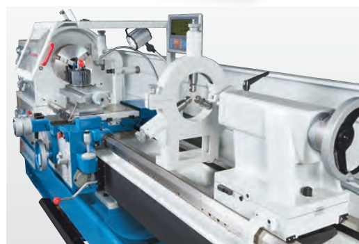
Lünetten zur präzisen Bearbeitung langer Werkstücke
