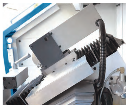
Schrägbettbauweise für optimierten Arbeitsraum und Späneabfuhr
