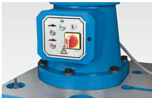
Stabiler Säulenfuß mit zentralem Hauptschalter
