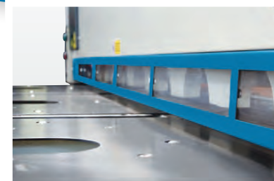
Die im Tisch eingelassenen Materialauflagekugeln erleichtern das Werkstückhandling
