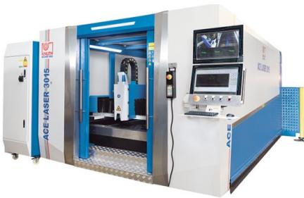
*El espacio de trabajo está protegido por un recinto de diseño ergonómico con ventanas de cristal de seguridad y dos puertas frontales con sistema de enclavamiento*
