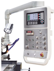
Avanzamento e velocità del mandrino possono essere commutati e regolati in modo continuo dal pannello di controllo
