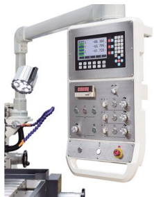
Подача и частота вращения шпинделя переключаются и плавно регулируются на панели управления
