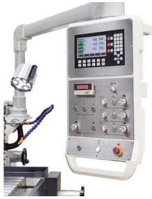
L'avance et la vitesse de broche peuvent être commutées et réglées en continu au Pupitre de commande.
