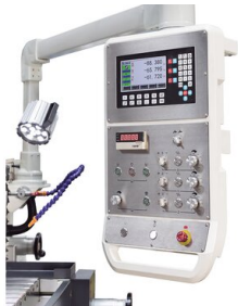
El avance y la velocidad del husillo pueden conmutarse y regularse de forma continua en el panel de control.
