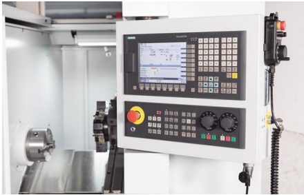
La torreta de herramientas puede equiparse con herramientas para mecanizado interior y exterior
