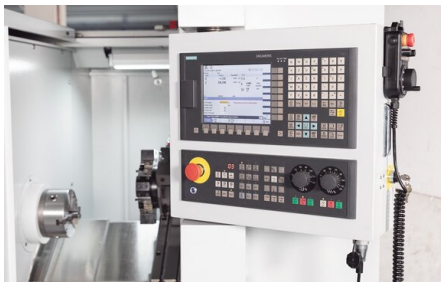
Nástrojový revolver lze osadit nástroji pro úpravu vnějšího a vnitřního povrchu
