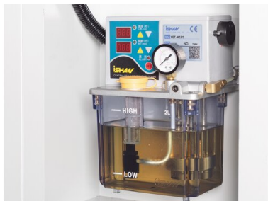
Automatické centrální mazání spolehlivě zásobuje všechna mazací místa a usnadňuje údržbu stroje
