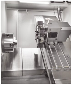
Der Werkzeugrevolver kann mit Werkzeugen für die Außen- und Innenbearbeitung bestückt werden
