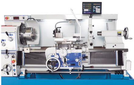
Camme di arresto regolabili che disattivano automaticamente l'avanzamento
