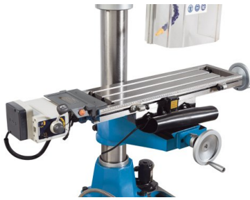
Stufenlos regelbarer automatischer Vorschub in der X-Achse
