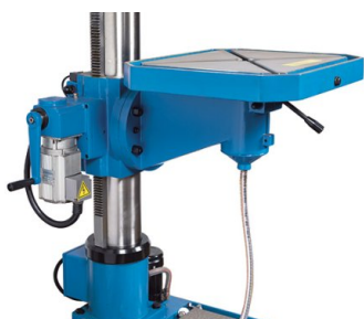
Приводной механизм регулировки высоты сверлильного стола
