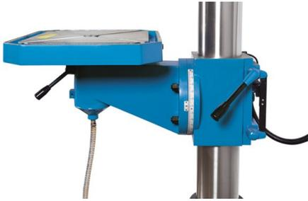
*Der Bohrtisch kann 45° rechts und links geschwenkt werden*
