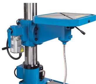
Stół wiertarski może być przesuwany na wysokość za pomocą silnika
