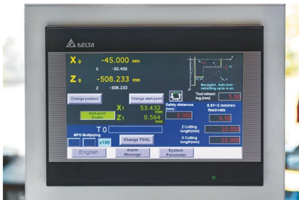
La pantalla táctil a color grande ofrece una pantalla gráfica de operaciones de maquinado e indica los parámetros editables
