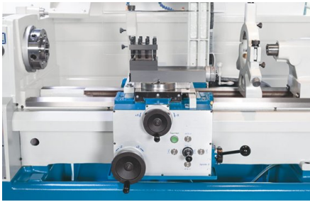
Los ejes están potenciados por servomotores de alta calidad que traducen los movimientos de su mano con la precisión y dinámica de modernas máquinas CNC
