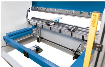
Опция: задний упор с управляемой осью R
