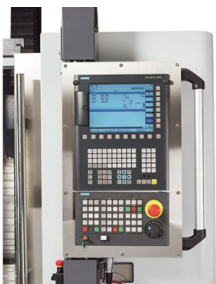
Unitatea de comandă SINUMERIK 828D, cu performanța sa CNC unică, stabilește noi standarde în materie de productivitate
