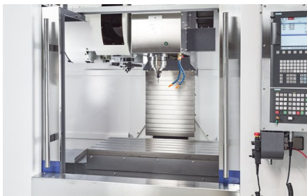
Schimbare rapidă a sculelor cu graifăr cu două brațe
