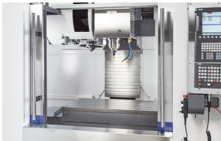
Rychlý měnič nástrojů s dvouramenným úchopem
