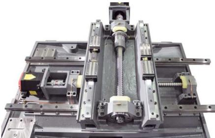
*Hochwertige Komponenten für Antrieb und Führungen garantieren Genauigkeit und Verfügbarkeit*
