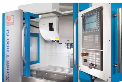
Cambiatensili rapido con pinza di prelevamento doppia e 24 posizioni
