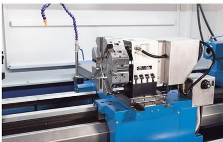
*Автоматическая 8-позиционная инструментальная револьверная головка с гидравлическим зажимом*
