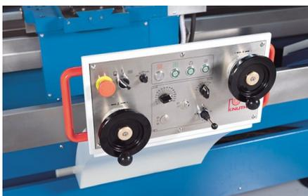
*Два электронных маховичка воспроизводят эргономику надежных традиционных станков, помогая быстро выполнять наладку и обработку в ручном режиме*
