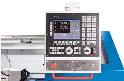
*ЧПУ Fagor 8055 дополнительно предлагает интуитивное программирование прямо на рабочем месте с помощью простых диалоговых окон с кнопками и поясняющей графикой*
