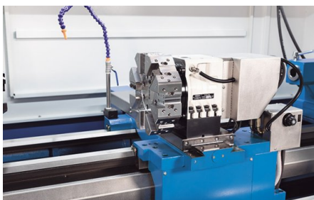
Automatická 8násobná revolverová hlava s hydraulickým upínáním
