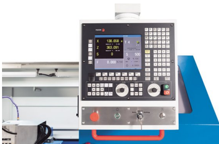
CNC řízení Fagor 8055 nabízí také intuitivní dílenské programování pomocí jednoduchého graficky podporovaného dialogového okna
