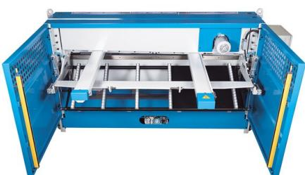
Die pneumatische Blechhochhaltevorrichtung ist umschaltbar und kann den Blechzuschnitt wahlweise zur Vor- oder Rückseite der Maschine leiten
