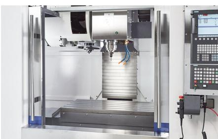
**Diese Maschine verfügt zudem nur über das Standard-Kühlmittelsystem mit Spänepülung. Auf die Kühlung durch die Spindel (IKZ) wurde hier verzichtet.**
