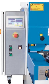
Panou de control MONITOUCH cu interfață om-mășină (HMI) de la Fuji Electric
