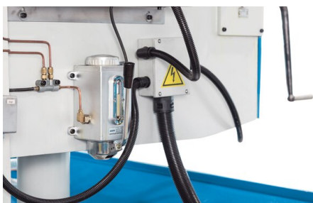
Lubrifierea manuală centralizată reduce costurile de întreținere și prelungeste durata de viață a mașinii
