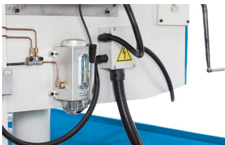
Une lubrification centrale manuelle réduit l'entretien et prolonge la durée de vie de la machine
