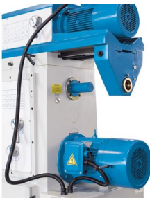
Broche horizontale à entraînement propre et boîte de vitesse avec réglage de précision
