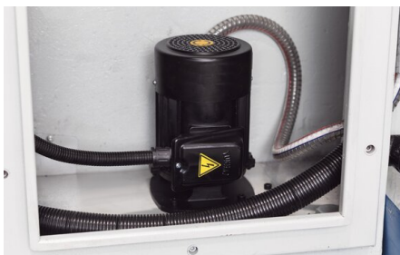
Une lubrification centrale manuelle réduit l'entretien et prolonge la durée de vie de la machine
