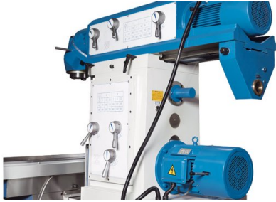
Husillo horizontal con su propio accionamiento y caja de cambios finamente escalonada
