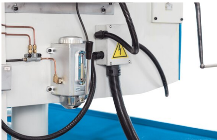
Eine manuelle Zentralschmierung reduziert den Wartungsaufwand und verlängert die Lebensdauer der Maschine
