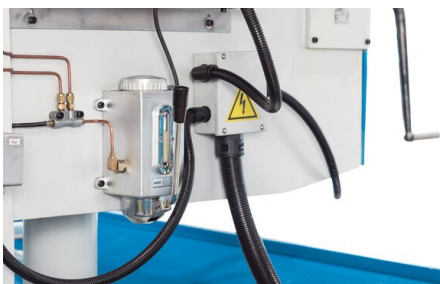
Ręczne smarowanie centralne redukuje nakłady na konserwację i wydłuża żywotność maszyny
