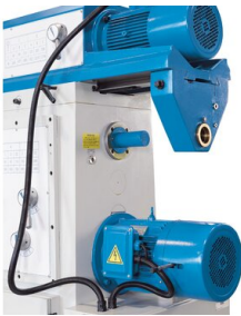
Wrzeciono poziome z własnym napędem i skrzynią biegów z precyzyjnym stopniowaniem
