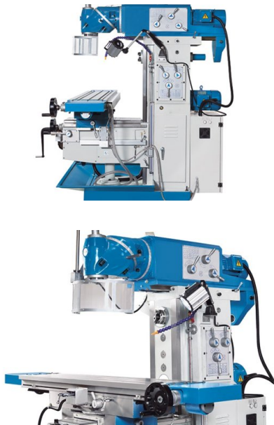
Arborele vertical și orizontal dispun fiecare de o propulsie separată
