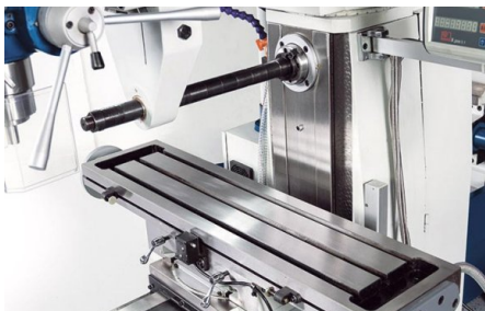
Der solide Oberbalken mit Gegenhalter ermöglicht die stabile Aufnahme langer Fräsdorne
