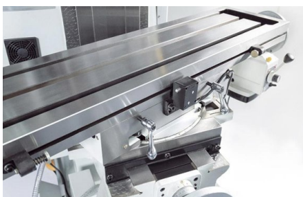
Stół frezarski przechyłany w osi X
